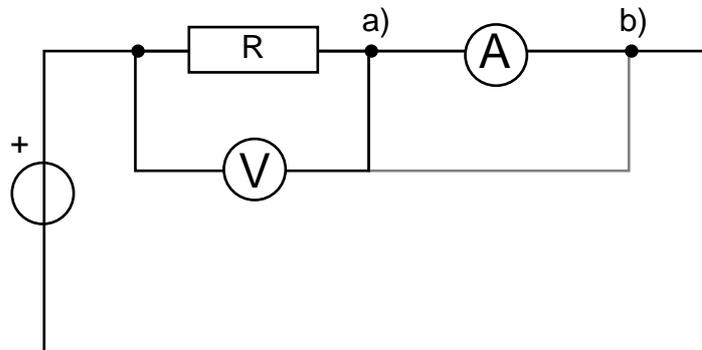
Will man den Strom durch den Widerstand und die Spannung am Widerstand gleichzeitig messen, gibt es ein Problem. Beide Grössen können nicht gleichzeitig genau gemessen werden. In Schaltung a) wird der Strom durch das Voltmeter mit gemessen, in Schaltung b) misst man die Spannung am Amperemeter mit. Wenn der fehlerhafte Wert klein ist, spielt es keine so grosse Rolle. Andernfalls muss man den richtigen Strom- bzw. Spannungswert durch eine Rechnung ermitteln.
