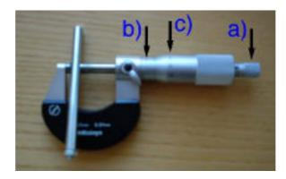
Messen Sie die Dicke des Werkstücks. Nehmen Sie eine Messserie auf und ermitteln Sie den Mittelwert, die Standardabweichung und den relativen Fehler.
