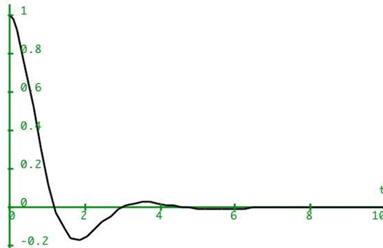
$\delta > \omega_0$ : Bei starker Dämpfung kommt der sogenannte 'Kriechfall' zustande.
