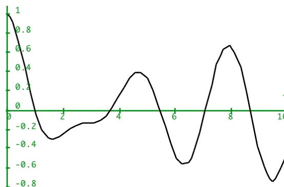
Das Diagramm zeigt, dass am Anfang die Lösung der homogenen DGL die Kurve stark beeinflusst. Mit steigender Zeit  $t$  wird sich aber die periodische Anregungskraft durchsetzen. Es ist hier bereits ersichtlich, wie die Schwingung des Pendels die Amplitude vergrößert (Resonanz).
